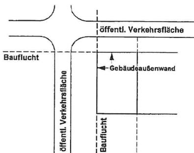
5.3. Ausnahmsweise kann im Einvernehmen mit der Gemeinde maximal ein oberirdisches Nebengebäude bis zu einer Größe von maximal 25 m<sup>3</sup> umbautem Raum auch vor der Bauflucht zugelassen werden, sofern dieses Nebengebäude der Unterbringung notwendiger Fahrradstellplätze im Sinne des § 35 Abs. 4 der Landesbauordnung für Baden-Württemberg dient. Dieses Nebengebäude wird nicht auf die zulässige Anzahl von Nebengebäuden nach Ziffer 5.2. angerechnet.
